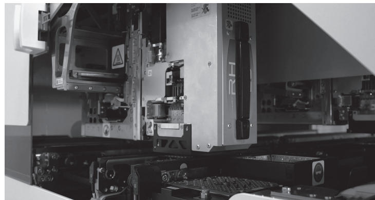
図2 電子部品実装ロボットの部品吸着ヘッド位置決め機構の例
