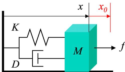
図 4.1: バネ・マス・ダンパによる機構系
