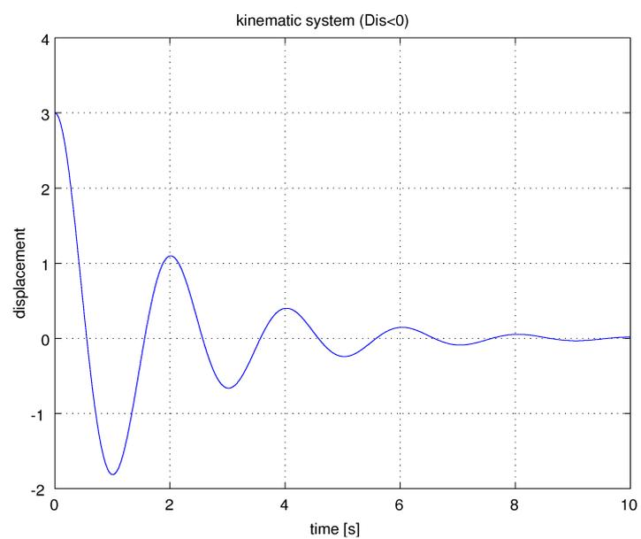
図 4.3: バネ・マス・ダンパによる機構系の過渡応答 ( $Dis < 0$  の場合)
