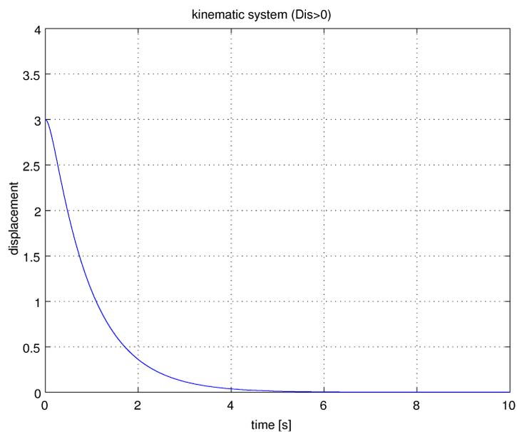
図 4.2: バネ・マス・ダンパによる機構系の過渡応答 ( $Dis > 0$  の場合)
